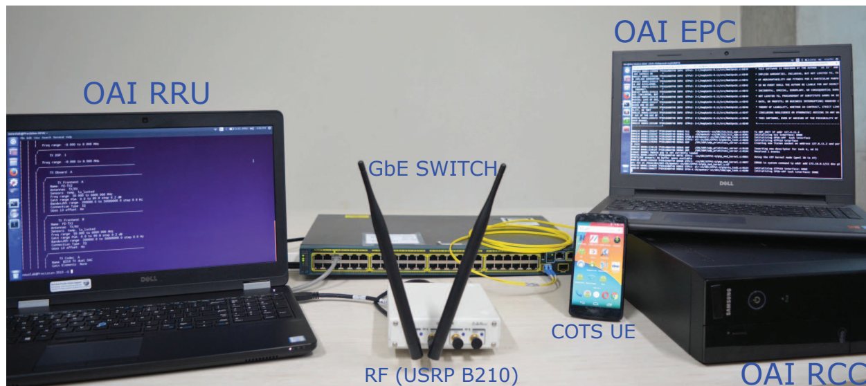
Fig. 3. C-RAN demo setup
